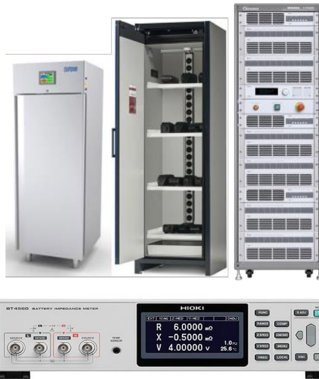
Figura 4 da sinistra a destra: camera climatica FDM T370s, sistema stoccaggio batterie ASECOS Type 90 e rack con ciclatori per celle e per moduli batterie CHROMA 17010/17020, in basso un analizzatore di impedenza Hioki per celle analogo a quello oggetto delle procedure di acquisto
